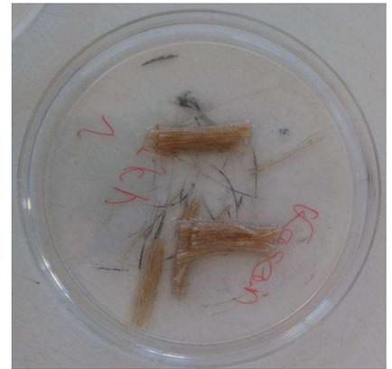
*Schaubild 10: Kaseinleim auf Milchbasis in Verbindung mit Flachsfasergelege; Nach dem Verlust der Klebkraft lösen sich die Gelege voneinander.*
